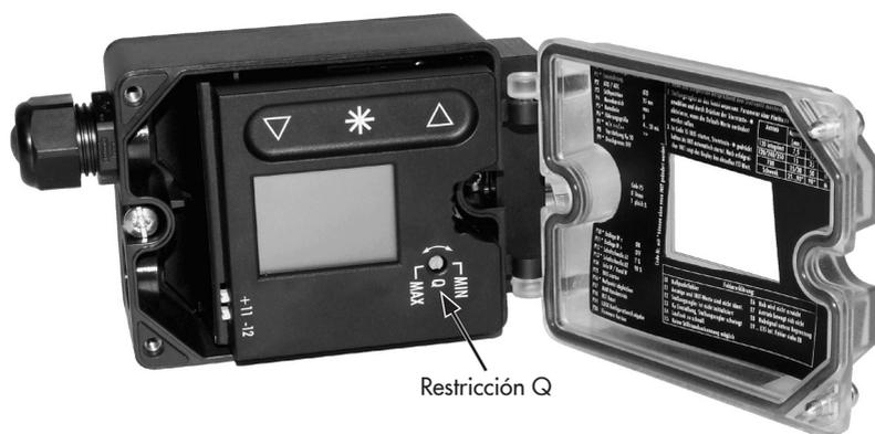
Fig. 20: Ajuste de la restricción de caudal Q (posición MAX/MIN) (imagen con tapa versión GI:00)
