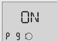
Activación de la limitación de la presión de mando (tener en cuenta el desbloqueo para configuración, ver cap. 7.2):
