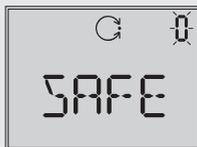
La válvula va a su posición de seguridad. Si el posicionador había sido inicializado se indicará la apertura actual de la válvula en %.
