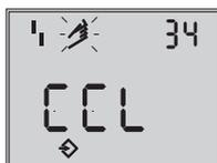
Sens de fermeture (sens de rotation permettant d'atteindre la position FERMÉE de la vanne ; visualisé sur l'écran du positionneur)
