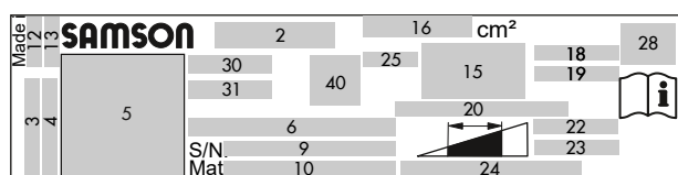
Fig. 1: Inscrições na placa de identificação dos atuadores Tipo 3271/3277 ou Tipo 2780 com área do atuador de 120 cm 2
