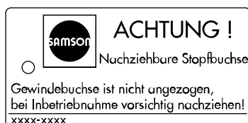
Bild 3: Schild bei nachziehbarer Stopfbuchspackung
